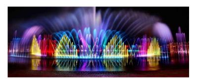
Mithilfe eines Laserprojektors und einer Leinwand, die aus einem Wasser-Luft-Gemisch besteht, das über die gesamte Länge des Brunnens verteilt ist, können 3D-Videos auf dem Brunnen demonstriert werden.
